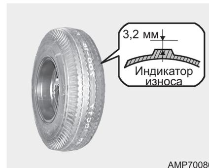
На оригинальных шинах, установленных на вашем автомобиле, предусмотрены индикаторы износа протектора. Они становятся видимыми, когда глубина протектора изнашивается до 3,2 мм (0,126 дюйма). Шину следует заменить, когда индикаторы износа приобретают вид сплошной полосы, проходящей через две канавки протектора или более. Производите замену шин на шины рекомендуемого размера. Если вы меняете колеса, ширина и вылет обода колесного диска должны отвечать требованиям HYUNDAI.
