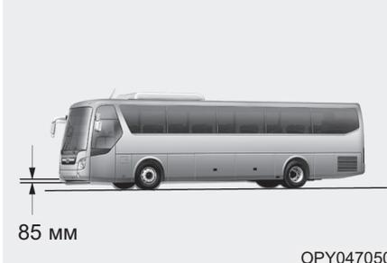
Эта система предназначена для опускания передней части автомобиля. Она позволяет упростить вход или выход из автомобиля.
