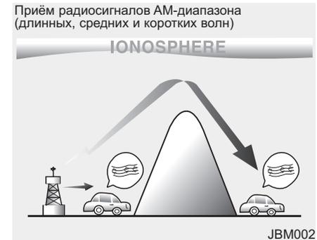
Сигналы AM-диапазона могут приниматься на большем удалении от радиостанции, чем сигналы FM-диапазона. Причина этого - в более низкой частоте радиоволн AM-диапазона. Эти радиосигналы с большой длиной волны и низкой частотой распространяются не по прямой линии в атмосфере, а могут огибать земную поверхность. Кроме того, они огибают препятствующие их распространению объекты, что обеспечивает лучший приём сигнала.
