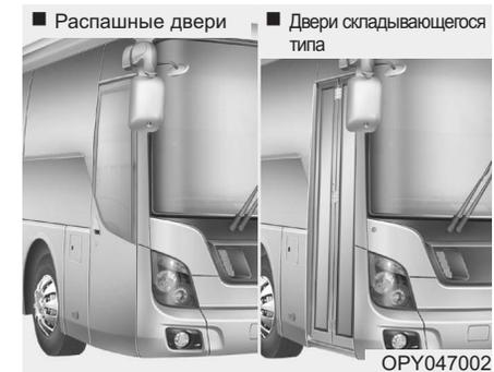
Существует два типа дверей - открывающаяся в обе стороны и складывающаяся.
