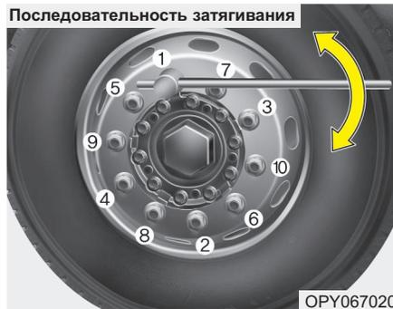
Момент затяжки гайки крепления колеса:
