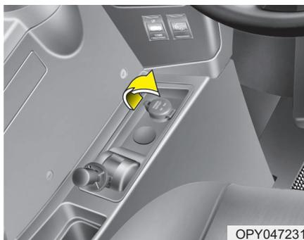
Чтобы её использовать, снимите с неё крышку. Она предназначена для питания электрических устройств (пылесоса, небольшого холодильника и пр.). Такие устройства должны потреблять менее 12V, 3A при работающем двигателе.
