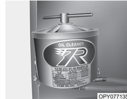
1. Поверните T-болт T-R маслоочистителя против часовой стрелки.
