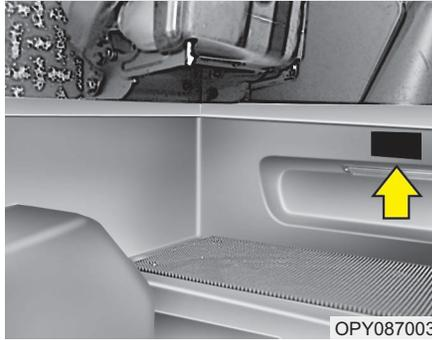
Эта пластина крепится на пол шага передней двери, как показано на рисунке, и показывает тип модели, номер шасси и номер двигателя. Идентификационный номер транспортного средства (VIN) - номер, используемый при регистрации транспортного средства и во всех юридических аспектах, имеющих отношение к его эксплуатации и пр.
